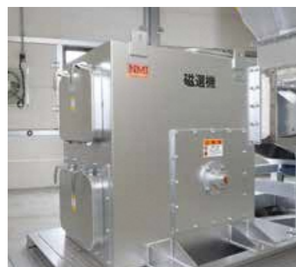
磁選機 焼却炉から取り出された不燃物から、さらに鉄分を選別するための設備です。
